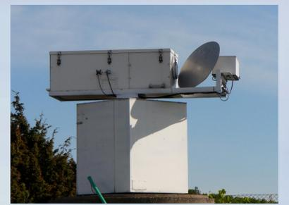
The Water Vapour Radiometer
