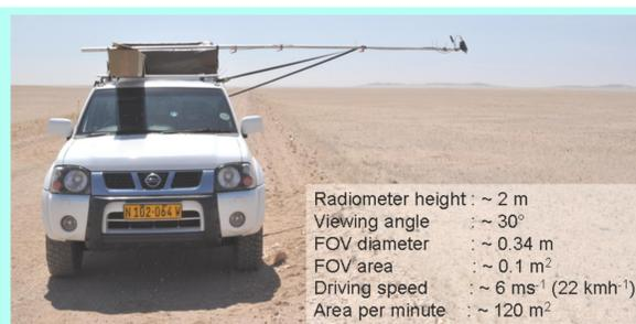
Radiometer height : ~ 2 m
