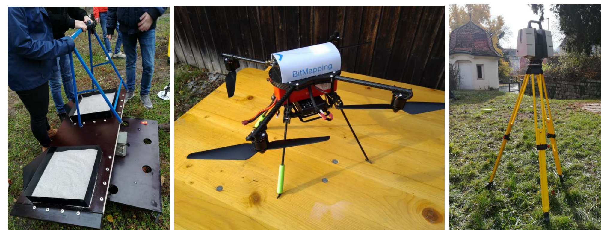
l.) Camera rack, m.) UAV with camera and r.) terrestrial laser scanner
