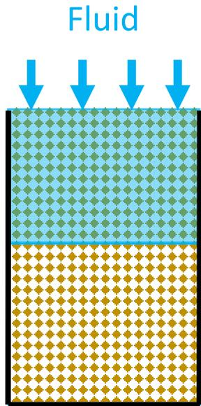
Fluid «piston» displaces air in porous rock
