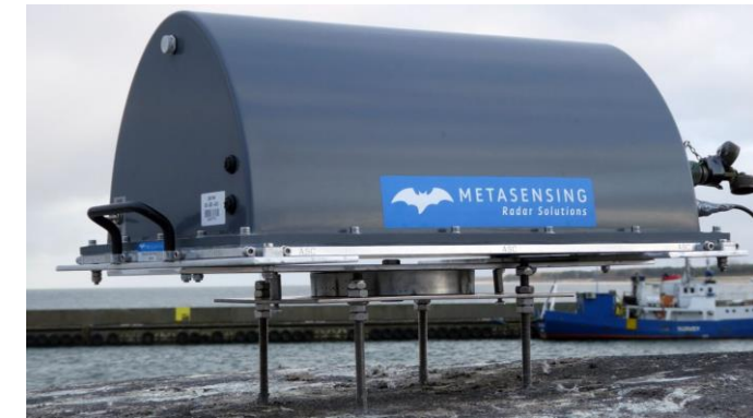
Electronic corner reflector in Władysławowo, Poland (WLAD) (photo by R. Zdunek)
