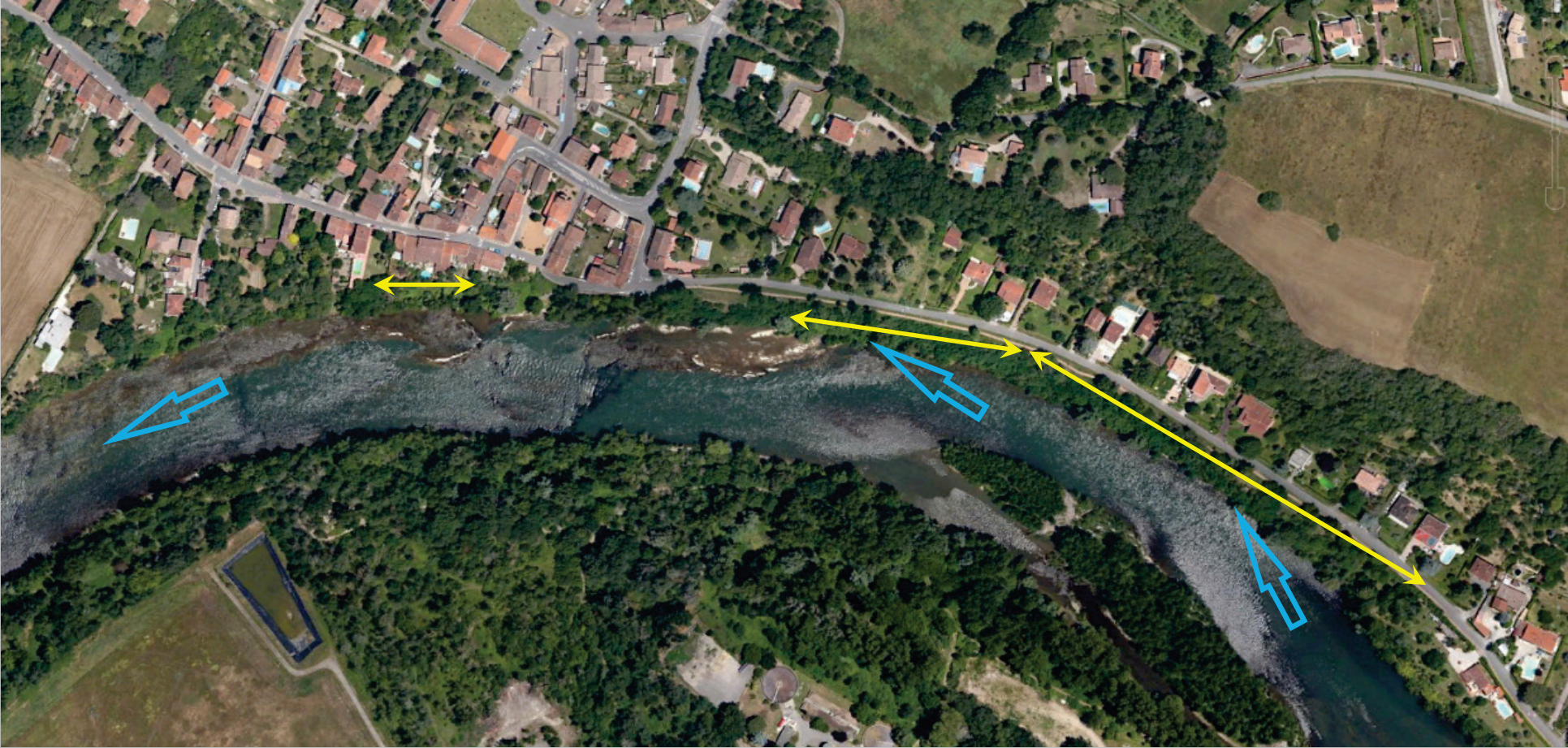
Fond Image GoogleEarthPro GoogleEarthPro im Juni 2012: Gelbe Linie zeigt geplanten Wiederaufbau mittels ingenieurbioischem und kombiniertem Uferschutz
