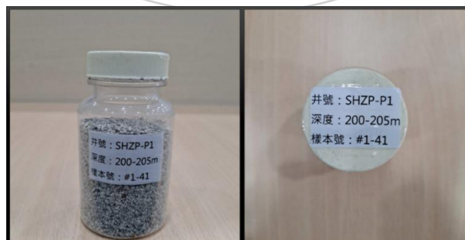
圖 4-4 岩屑樣本罐書寫範例示意圖
