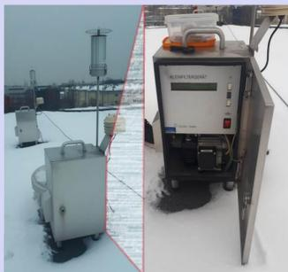
Fig. 1. Low-volume sampler LV Leckel.
