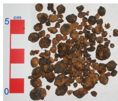
Figura 6 - Concrezioni ferro manganesifere
